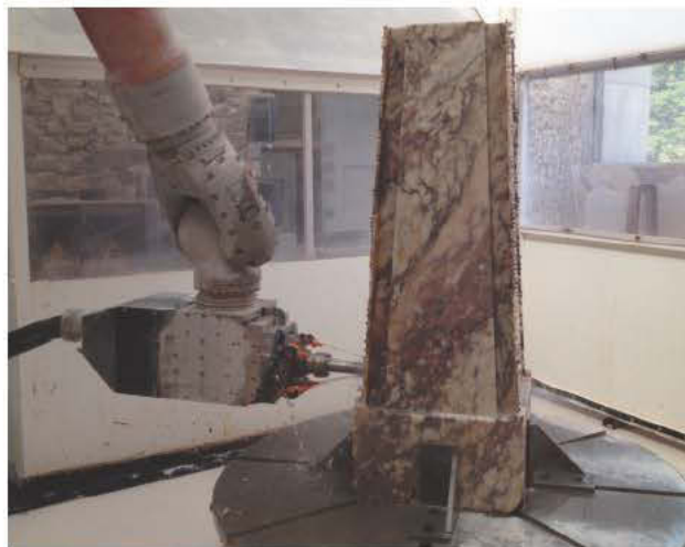
Fig. 17. Saint-Pons-de-Thomières (Hérault), société SAMAC-Marbres de France ; robot sept axes ébauchant le guéridon. © Galerie Armel Soyer.
